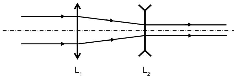
Na tako postavljene leće pada paralelni snop svjetlosti usporedno s optičkom osi leća. Nakon prolaska kroz obje leće, snop svjetlosti ostaje paralelan i usporedan optičkoj osi leća.
