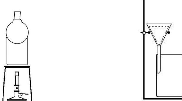
**Slika 1.1.** Uređaj za sublimaciju**Slika 1.2.** Uređaj za filtraciju
