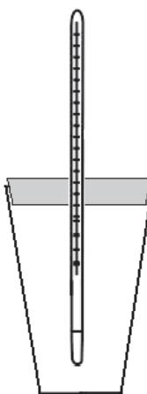
Slika 6. Crtež jednostavnog kalorimetra
