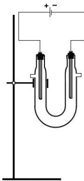
**Slika 5.** Uredaj za elektrolizu vodene otopine natrijeva sulfata
